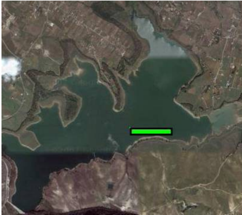
Figura 3: Foto satellitare del lago Piana degli Albanesi (3,3 km 2 ) con il riquadro di un impianto da 100.000 m 2
