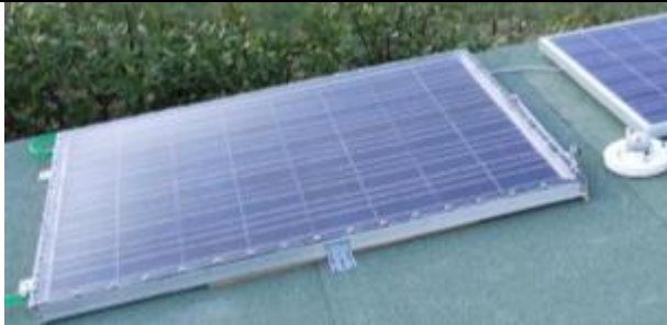
Figura 9 Prototipo 1 : alluminio e policarbonato
