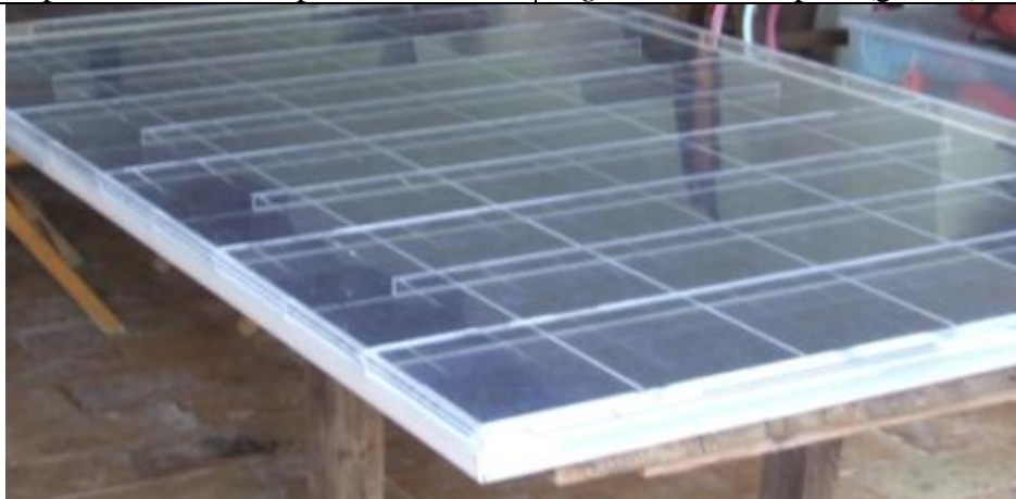
Figura 11 Prototipo 3 in policarbonato: l'acqua è direttamente a contatto col pannello PV
